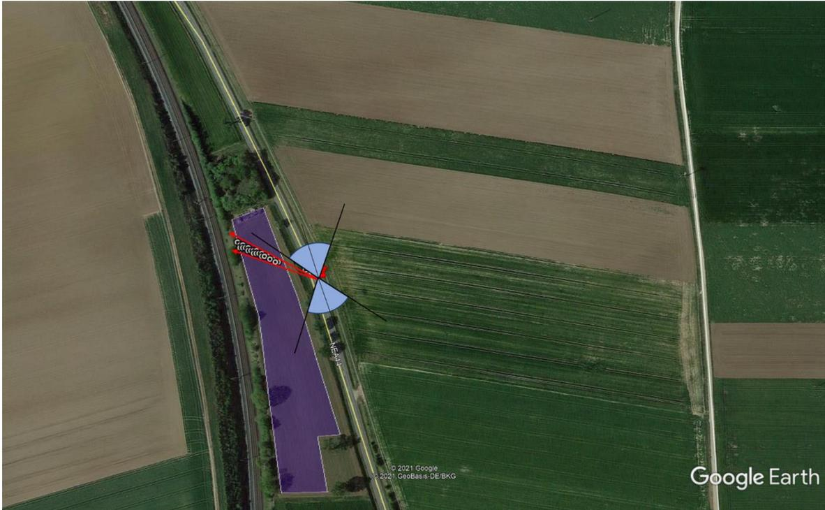
Vergleich Sichtfeld Fahrzeugführer für Punkt B3 mit Grenzvektoren in Richtung Module
