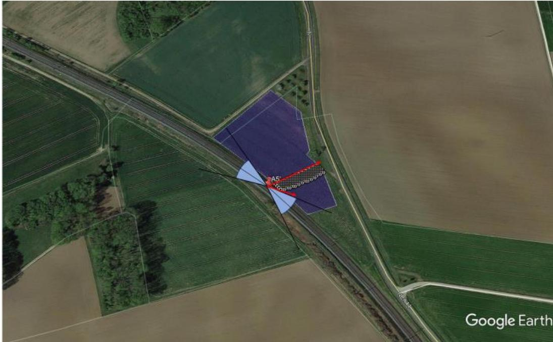
Vergleich Sichtfeld Zugführer für Punkt A5' mit Grenzvektoren in Richtung Module
