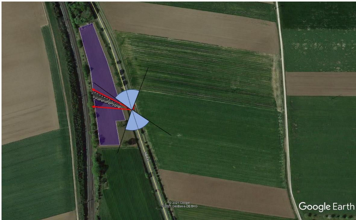
Vergleich Sichtfeld Fahrzeugführer für Punkt B2 mit Grenzvektoren in Richtung Module
