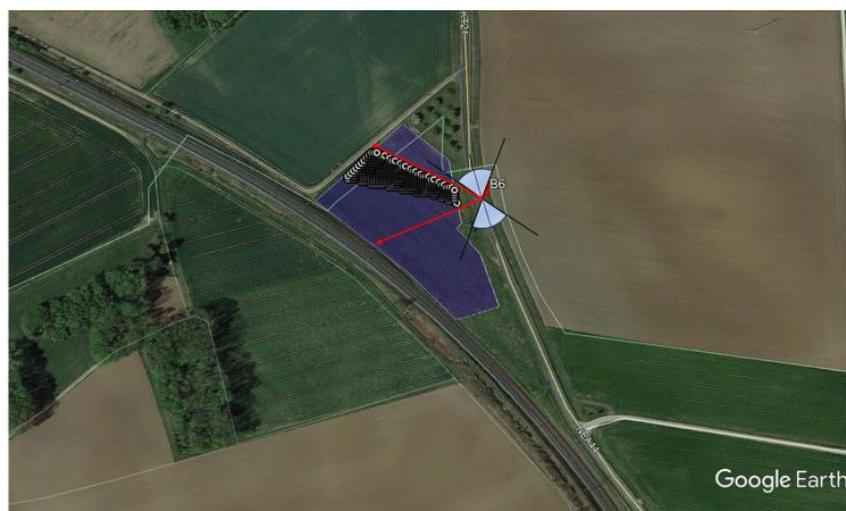
Abbildung 21: Vergleich Sichtfeld Zugführer für Punkt B6 mit Grenzvektoren in Richtung Module
