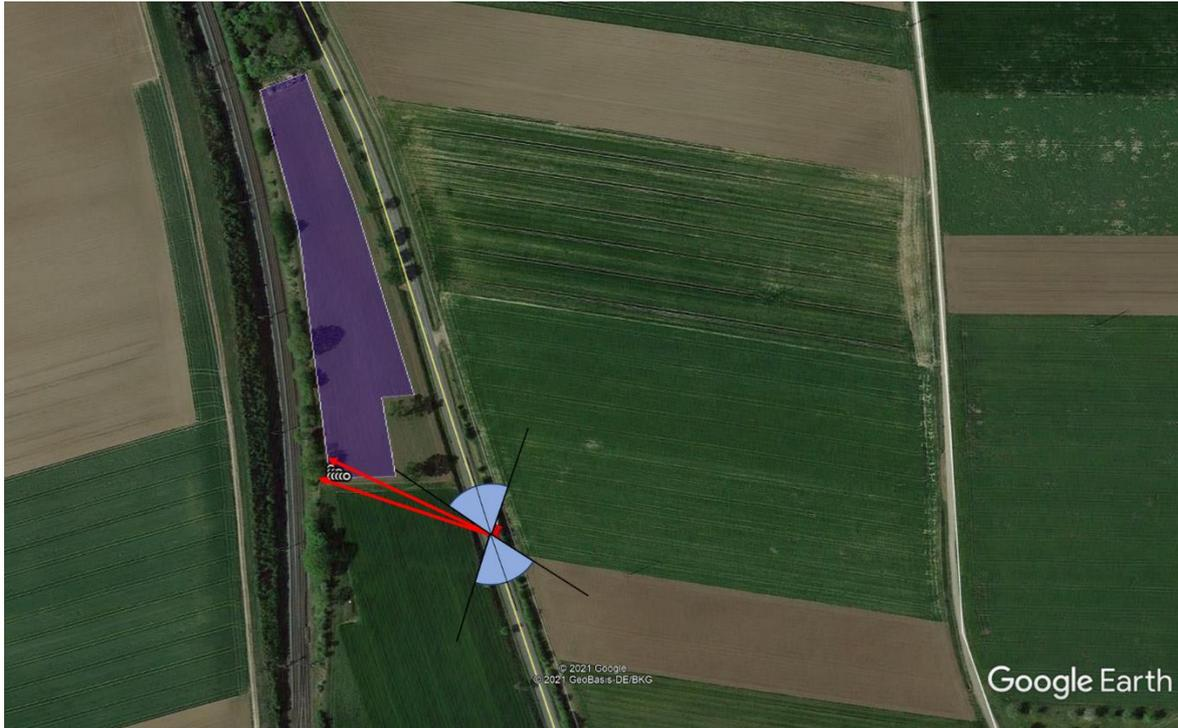
Vergleich Sichtfeld Fahrzeugführer für Punkt B1 mit Grenzvektoren in Richtung Module
