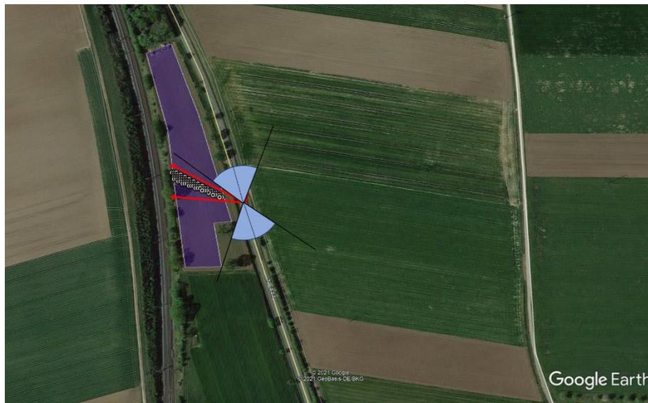
Abbildung 20: Vergleich Sichtfeld Zugführer für Punkt B2 mit Grenzvektoren in Richtung Module
